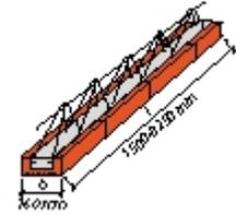
Deckendicke 210 mm - max. Länge des Deckenträgers 6 250 mm
