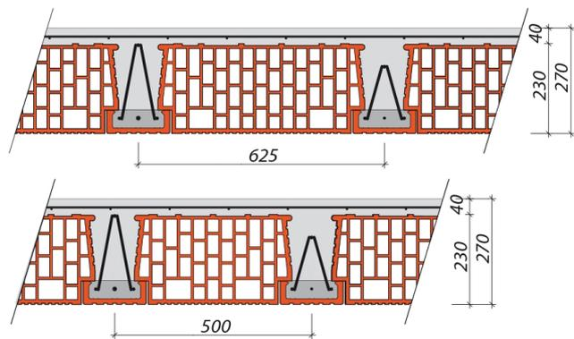
Deckendicke 230 mm - max. Länge des Deckenträgers 6 250 mm
