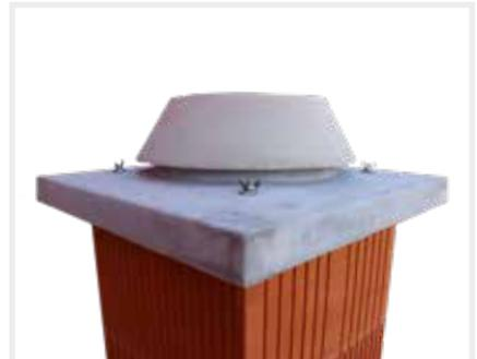
**10. Angepassten und geschnittenen Kamineinsatz reinigen, Fugenmasse auftragen und den Schornsteinkragen aufsetzen. Wischen Sie die überschüssige Fugenmasse ab und reinigen Sie die Fuge. Zwischen der Oberkante der Abdeckplatte und der Unterkante des Kragens muss ein Spalt von 15 mm eingehalten werden, um die Belüftung zu gewährleisten.**
