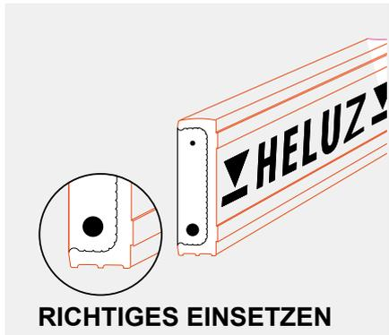
②c Richtiges Einsetzen des Sturzes - Schnitt mit Nuten.
