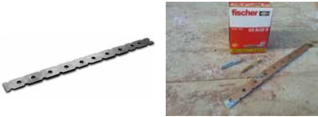
Flache Wandanker FD KSF aus Edelstahl, in der Stärke 0,7 mm, Breite 20 mm und Länge 300 mm, stellen den Verbund der Trennwände oder auch der tragenden Innenwände mit dem Außenmauerwerk sicher (Trennwände werden in den Ecken mit Verband gemauert).
